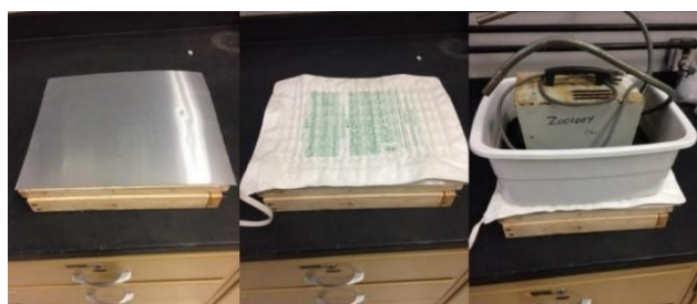
شکل ۵: ترتیب قرارگیری بخش‌های مختلف دستگاه برداشت کرم سفید. ۱- وزنه، ۲- منبع حرارتی (زرد رنگ)، ۳- صفحه آلومینیومی (قرمز)، ۴- عایق، ۵- دیواره‌های کناری چوبی، ۶- توری (چشمه ۲/۵ mm)، ۷- پایه‌های چوبی، ۸- صفحه پلکسی گلاس (پلاستیک شفاف) (Pompeo, 2017)
