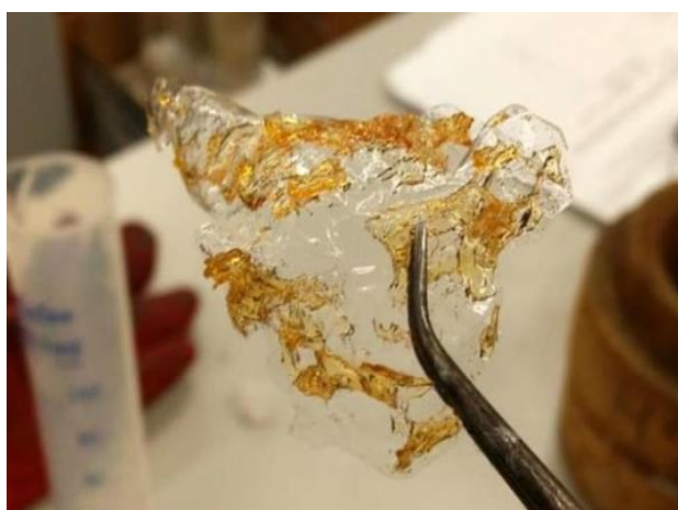
شکل ۳: فیلم کیتوسان تولید شده در مراحل اولیه ساخت
